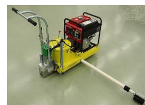
レール研磨機 (さび取り)
